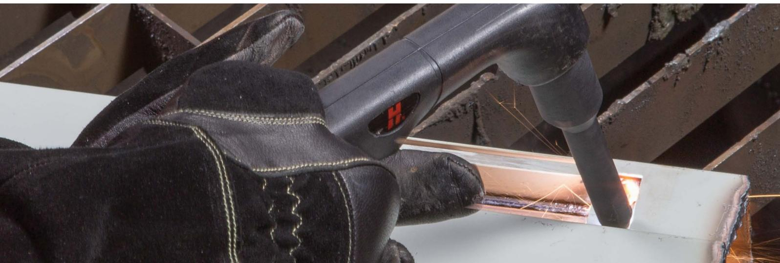
Consumíveis patenteados com comprimento extra e um perfil mais estreito para corte e goivagem em áreas de difícil acesso.
