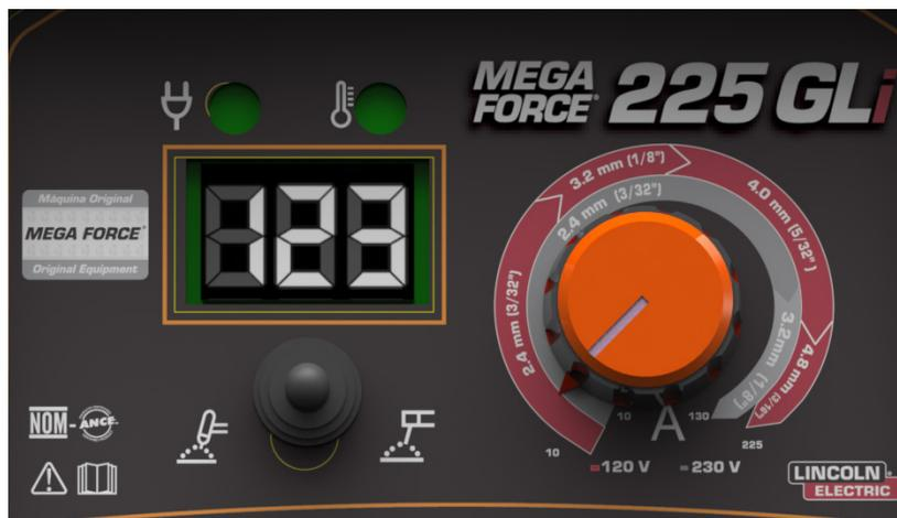
Os equipamentos da linha **MEGA FORCE®** possuem um controle da corrente de saída intuitivo (indica a corrente aproximada no botão de ajuste de saída de acordo com o diâmetro do eletrodo a ser usado) que facilita o ajuste por parte do operador).
